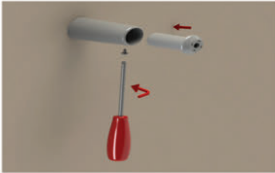
c) 2 numaralı parçanın içine 4 numaralı parçayı geçirip alttan 5 numaralı vida ile iki parçanın bağlanmasını sağlayın.
