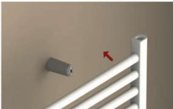
d) Plastik parçaları duvara sabitledikten sonra havlupanı duvara doğru yaklaştırıp plastik parçaların üzerine getirin.
