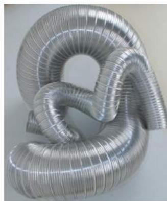
Alüminyum kanallar, çoğunlukla mutfak bacası havalandırma ve hafif görev hava hareketi uygulamaları için kullanılan yarı riyit kanallardır. Alüminyum borular oluklu şekilde ve yuvarlak bir kanal oluşturmak sureti ile düz olarak haddelenmiş ince alüminyum folyodan üretilir.
